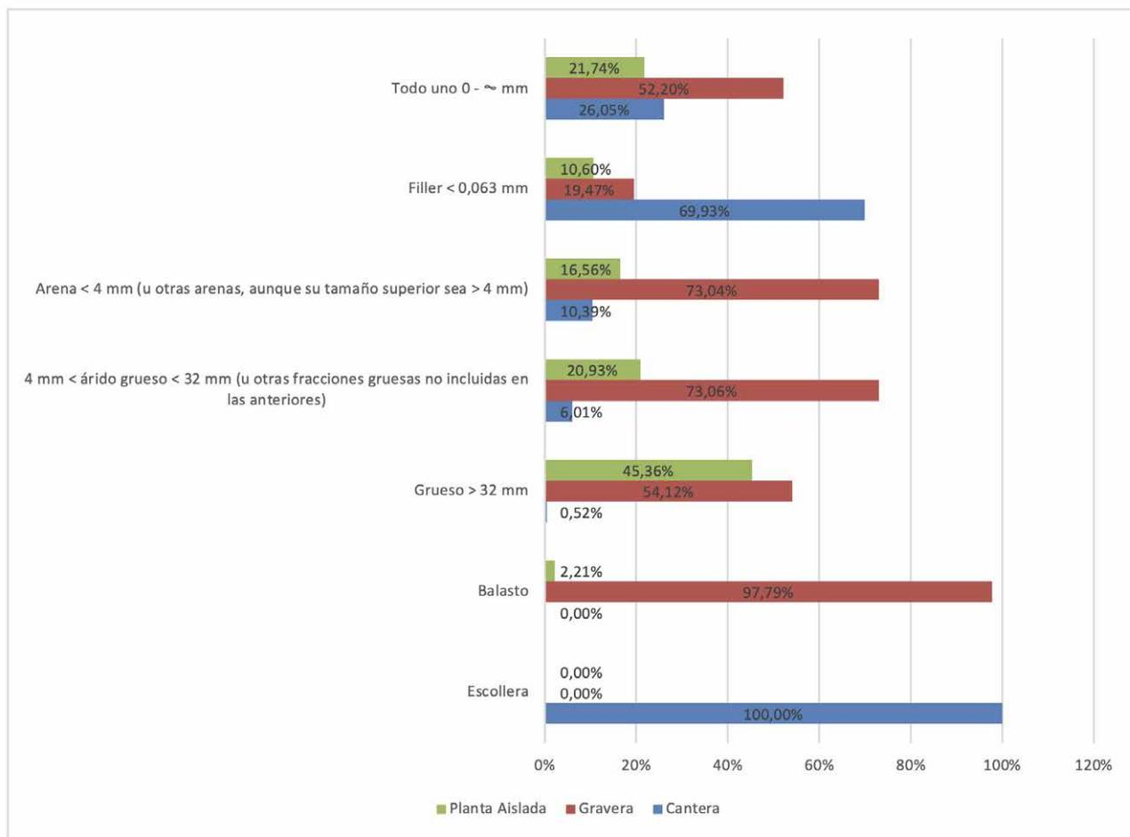
Gráfico 25. % de fracción granulométrica de árido natural no triturado producido según el tipo de instalación.
