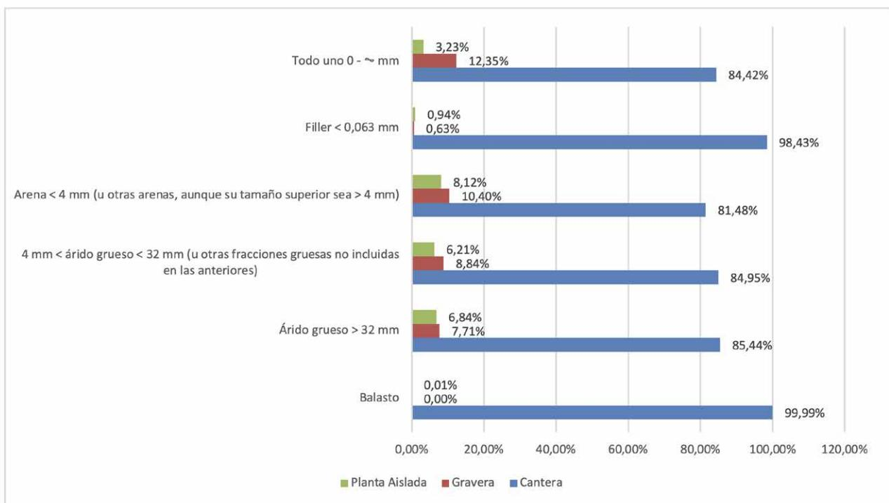
Gráfico 24. % de fracción granulométrica de árido natural triturado producido según el tipo de instalación.
