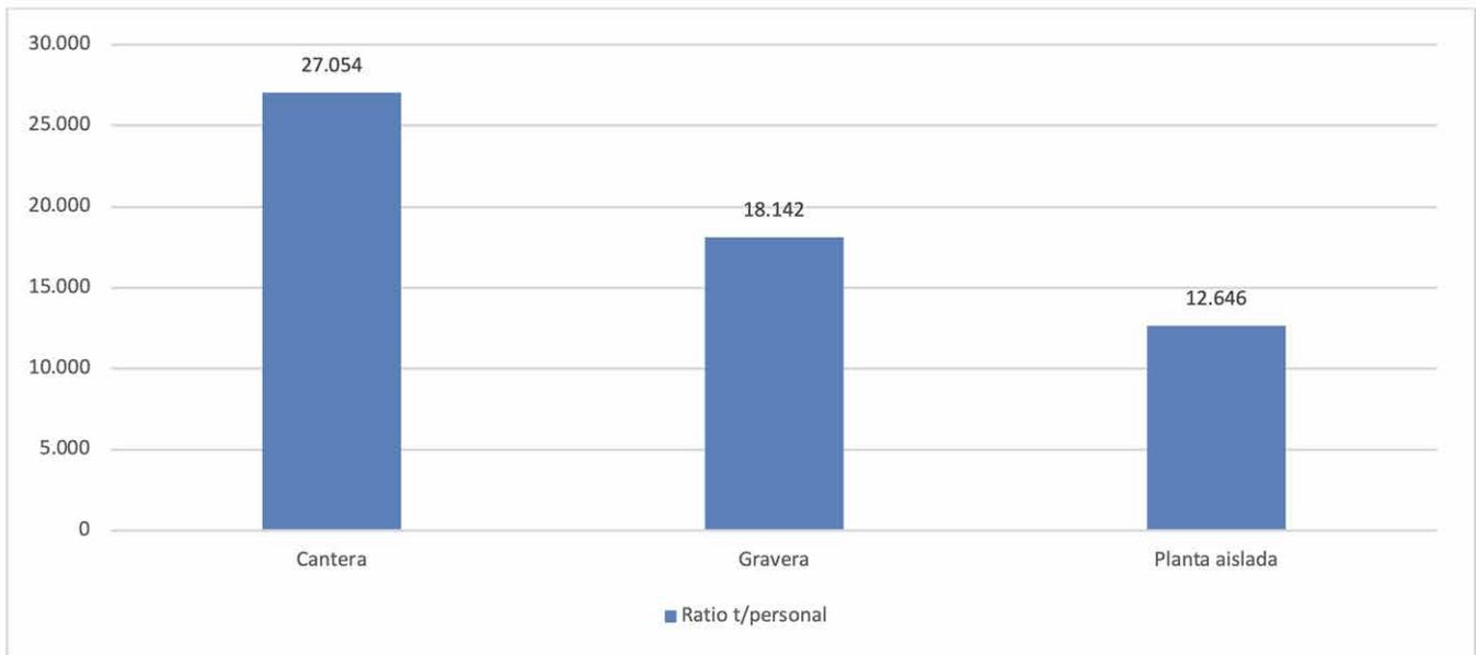
Gráfico 9. Ratio de t<sub>áridos</sub>/personal propio según el tipo de instalación.
